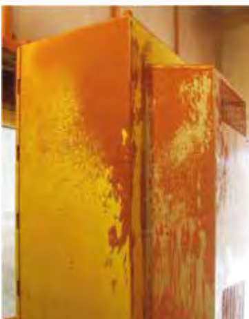
Prüfung Schutzart IP65 nach abgeschlossener dynamischer Druckfestigkeitsprüfung
